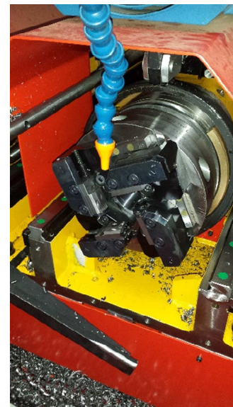
Exemple de montage 2 Sur une broche CNC de décolletage
